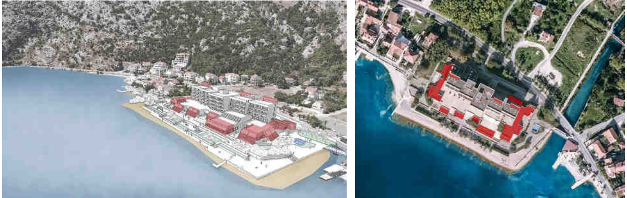
Slika 3.2. Crvenom bojom prikazana redukcija postojećeg objekta u prizemnom postamentu
